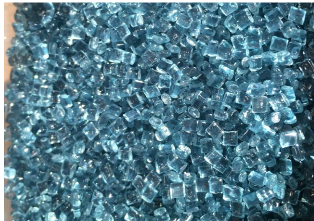
Image 2 : Les granulés de PET obtenus après extrusion
